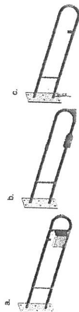
il. 100. Przykłady pochwyłków uchynych z przyciskiem pneumatycznym (a), przyciskiem radiowym (b) i przyciskiem elektrycznym (c) do spłukwania wody
